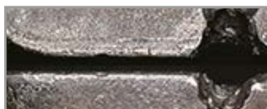
Nuance conventionnelle : Usure en entaille
